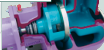
Gleitringdichtung aus Hart/Hart/Viton® mit Edelstahl Wellenschutzhülse und Schmierung hinter den Gleitflächen, zur Verbesserung der Trockenlaufeigenschaften.
